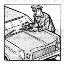
der Scheibenwischer wird im besten ist es neue zu besorgen. Bei elteren Fahrzeugen ist allerdings oft die Feder und damit der Anpreßdruck des Scheibenwischerarms er-lehmt. Dann empfiehlt sich das Aus-wechseln der kompletten Scheibenwischer.
